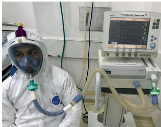
Figura 2 – Testagem da máscara Owner adaptada ao ventilador mecânico tradicional (SERVO-S, Maquet Critical Care, São Paulo, SP, Brasil) em indivíduo saudável
